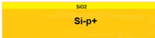
Şekil 33. Silisyum altlık üzerinde 1000 °C'de 10 dakika oksidasyon ile silisyum oksit ( SiO_2 ) tabakası oluşturulmuş yapının kesiti.
