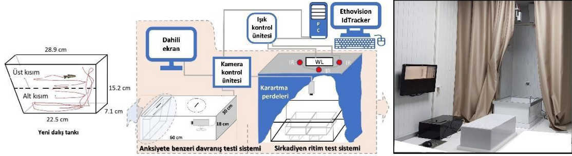
Şekil 7. Ergin balık anksiyete testinde kullanılan dalma tankı (Egan vd., 2009) ve sirkadiyen ritim test sistemi.
